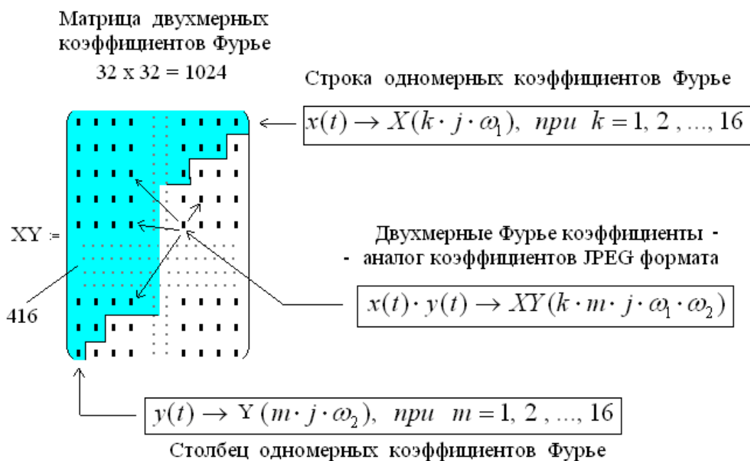
Рис. 6. Матрица двумерных коэффициентов Фурье, используемых как биометрические параметры в среде моделирования «БиоНейроАвтограф».
